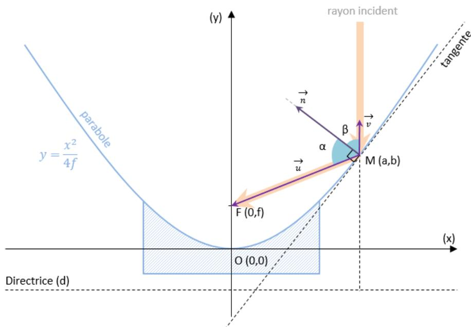
Considérons le point  $M$  sur la parabole ainsi que la droite tangente à la parabole au point  $M$  d'équation  $y = mx + p$ . Le vecteur  $\vec{v}$  est parallèle au rayon incident et le vecteur  $\vec{u} = \overrightarrow{MF}$  est parallèle au rayon réfléchi au rayon réfléchi. Le vecteur normal  $\vec{n}$  est le vecteur perpendiculaire à la tangente.
